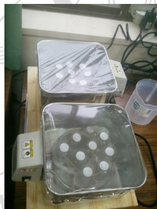
左、発酵実験の準備。基質に用いるヒサカキの乾燥粉末を、接種源のサルの糞との重量比が一定になるように計量して用意しています。瓶の中に入っているのは、糞とパッファを混合した懸濁液です。右、発酵実験中。二酸化炭素を充填し密栓したあと、37度のウォーターバスにつけて、24時間嫌気状態を保って発酵させます。
